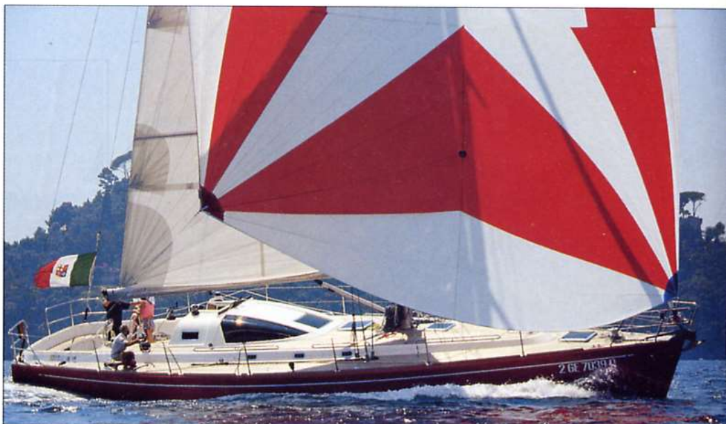
La carena potente e i parametri progettuali piuttosto spinti fanno dell'Oceano 54 una barca a vela pura, molto agile anche con vento leggero; di stampo prettamente crocieristico la coperta.
