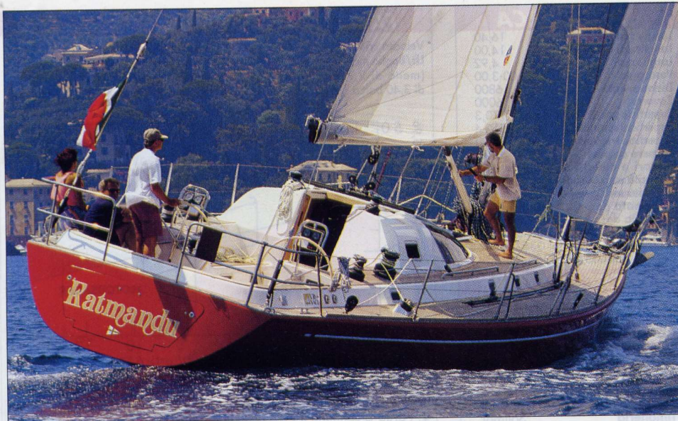
La prova ha evidenziato un comportamento equilibrato in tutte le andature, con punte di velocità di 9 nodi sotto gennaker e di 7,5 in bolina, con 13 nodi di vento reale. Alta la stabilità di forma.
