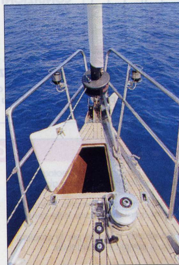
Il profondo gavone dell'ancora col verricello esterno da 1500 Watt.
